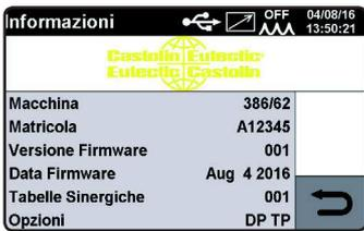
À l'amorçage de la machine, l'afficheur visualise pendant quelques instants: Le numéro d' article de la machine, le numéro de matricule, la version du Micrologiciel, la date de développement du Micrologiciel, le numéro de release du tableau des courbes synergiques et les options liées au générateur.
