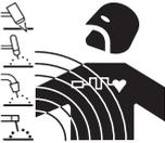
· Le courant électrique traversant n'importe quel conducteur produit des champs électromagnétiques (EMF). Le courant de soudure ou de découpe produisent des champs électromagnétiques autour des câbles ou des générateurs.
